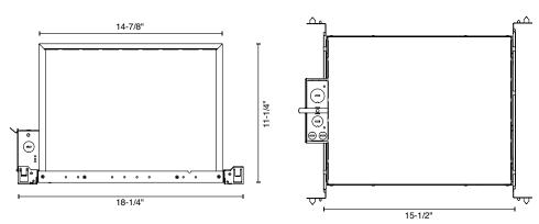
CP - CHICAGO PLENUM ICAT - INSULATION CONTACT / AIR TIGHT TRIM/TRIMLESS
